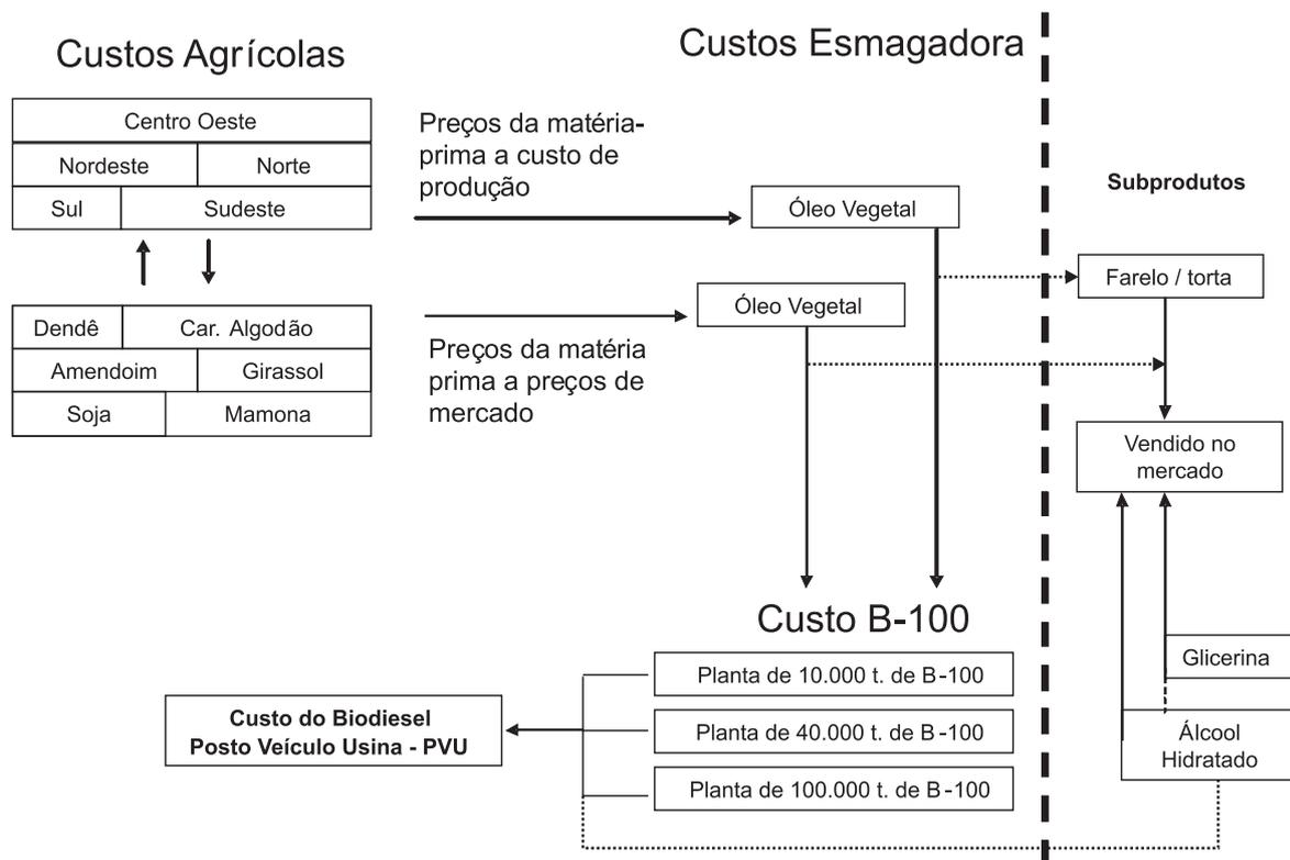
**Fig. 1.** Esquematização dos centros de custos para os cálculos de custo do biodiesel – Posto Veículo Usina (PVU).
